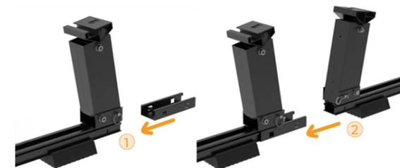
2.2 Richten Sie die drei verbundenen Schienengruppen quer aus und platzieren Sie sie an der gewünschten Position, sodass der Abstand der Gruppen der Länge des Solarmoduls entspricht, z.B. 176cm.
